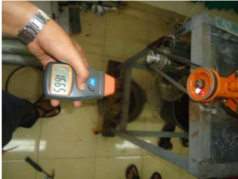
Gambar.5 Proses pengukuran kecepatan putaran pompa
