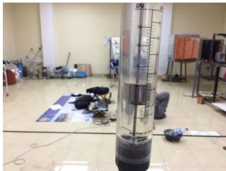
Gambar.8 proses pengukuran kapasitas aliran menggunakan flow meter
