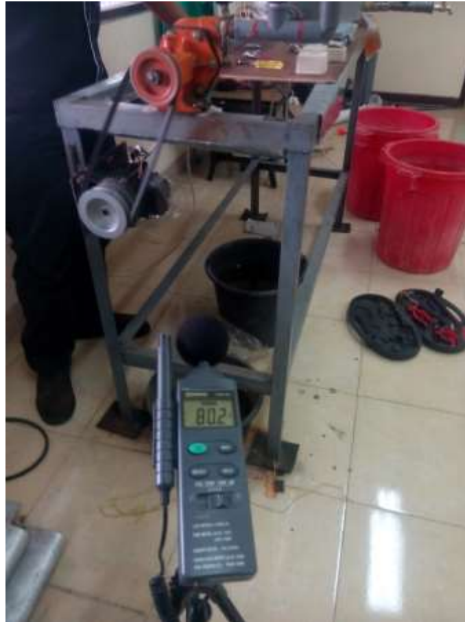
Gambar 11. Pengukuran kebisingan menggunakan sound level meter
