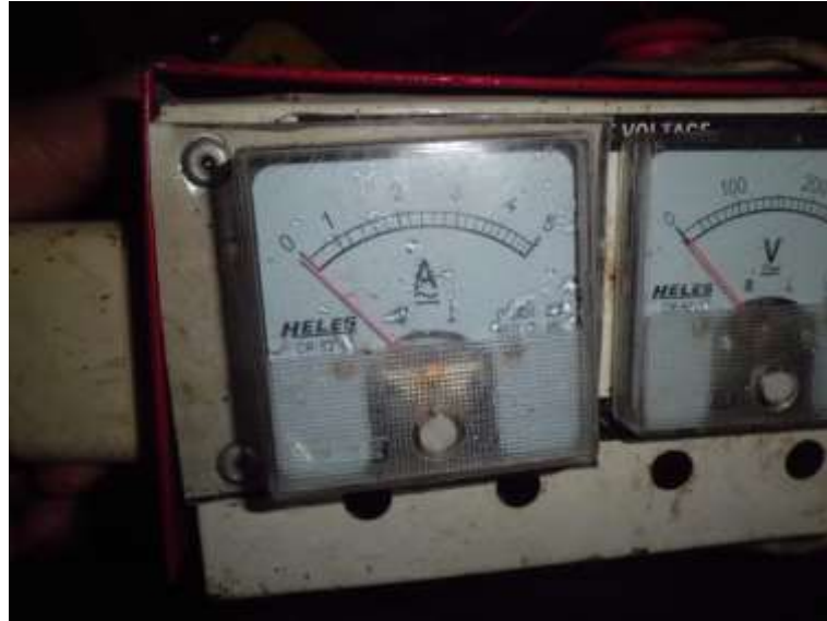
Gambar.1 volt meter dan ampere meter untuk mengukur konsumsi daya listrik motor
