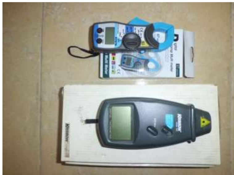
Gambar.2 digital clamp meter untuk mengukur arus listrik dan tegangan listrik dan tachometer untuk mengukur putaran.
