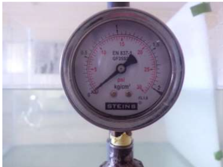
Gambar.4 Pressure gage positif untuk mengukur tekanan discharge pompa
