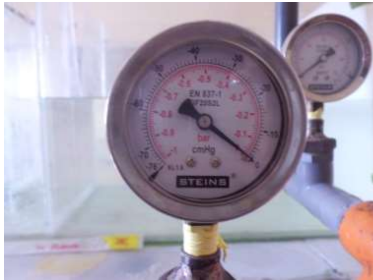
Gambar.3 Pressure gage negative untuk mengukur tekanan inlet pompa
